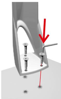
**IT** Fissare la gamba in fusione di alluminio con le viti e rondelle in dotazione utilizzando la chiave a brugola indicata a pag.1.
